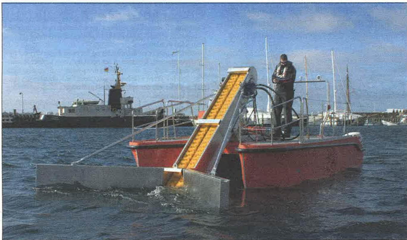
SWORC-fartøjet kan opsamle olie tæt under kysten, også selvom vandybden ikke er mere end 35 centimeter.
