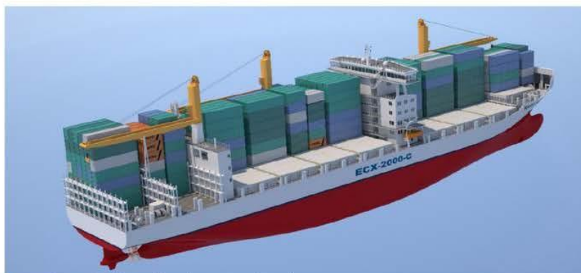
Det 2.000 TEU store Bangkok-max-skib med kontraroterende propellere.
