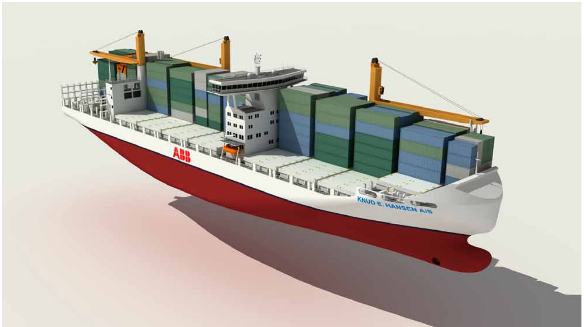
Op til fem lag af de højere high-cube containere kan stables i lasten. Dertil kommer seks lag over lugerne. Designet findes i både en gearet og en gearless version. Uden kraner er kapaciteten op til 2.116 high-cube TEU. Den maksimale reeferkapacitet er på 1.184 TEU.
